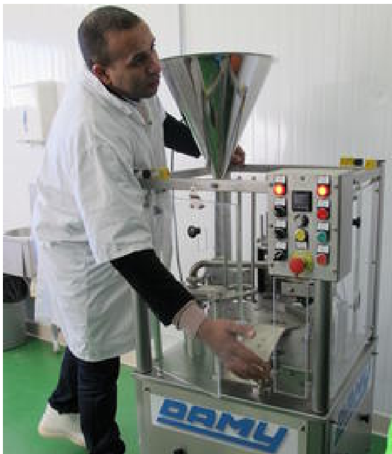
La machine permet de conditionner 1 800 pots à l'heure. LP/Aurélié Foulon.
